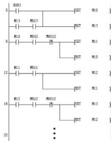
图 5 使用 M8012 强制跳步暂停
