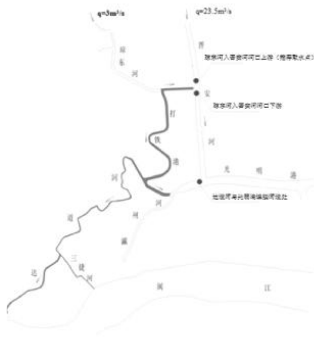
图2 设引水泵站从晋安河取水方案示意图
