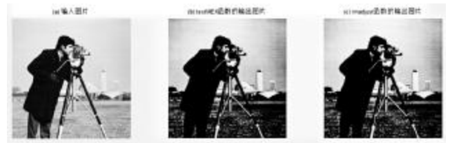
图 6 (a)输入图片,(b)testMEX 函数的输出图片, (c)imadjust 函数的输出图片
